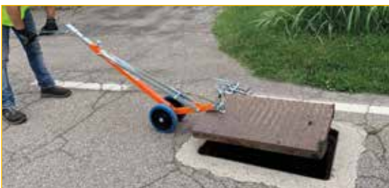
Utilizzo 3: sollevamento meccanico con morsetti di bloccaggio.
