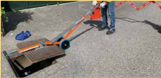
Utilizzo 1: sollevamento magnetico con singolo CL10 o CL11.
