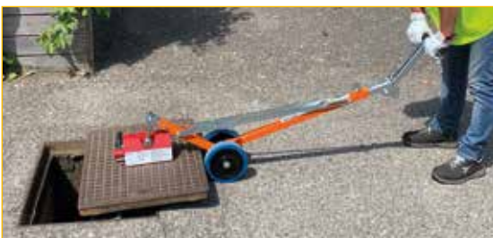
Utilizzo 4: sollevamento magnetico con magnete permanente (PM400 o PM500) per chiusini molto pesanti.
